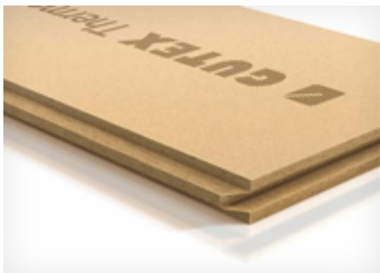
GUTEX Thermowall-gf est un panneau support d'enduit particulièrement résistant à la pression et stable en 40 ou 60 mm d'épaisseur – idéal pour pose directe sur des montants en bois dans le système Thermowall ITE écologique.
